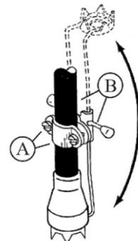
**Hinweis:** Für Gehstöcke mit einem größeren Durchmesser liegen der Eiskralle zwei längere Schrauben bei. Diese müssen nur gegen die kurzen, bereits in der Halterung befindlichen Schrauben ausgetauscht werden.
